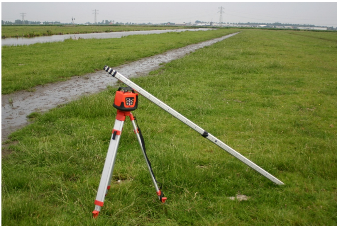
Foto 3. De apparatuur waarmee de hoogte van de peilbuizen t.o.v. het slootpeil is gemeten.
