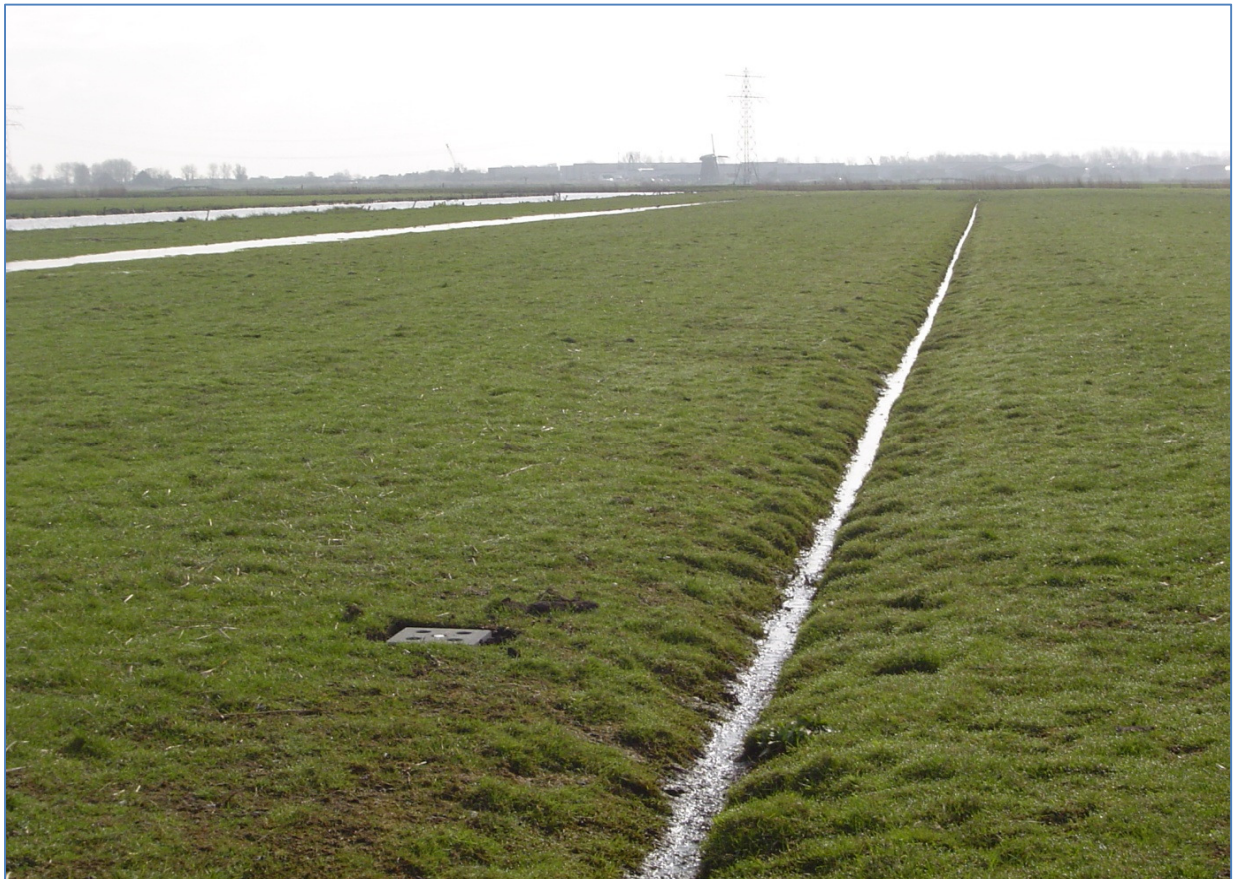
Foto 2. Ook in de controlegreppel kan op het bedrijf Al water staan, maar dat is altijd minder dan in de plasdrasgreppel (op de achtergrond (links). Op de voorgrond in de straattegel bevindt zich het meetpunt B1.1, gelegen op 1 m. van de greppel (4 april 2012).
