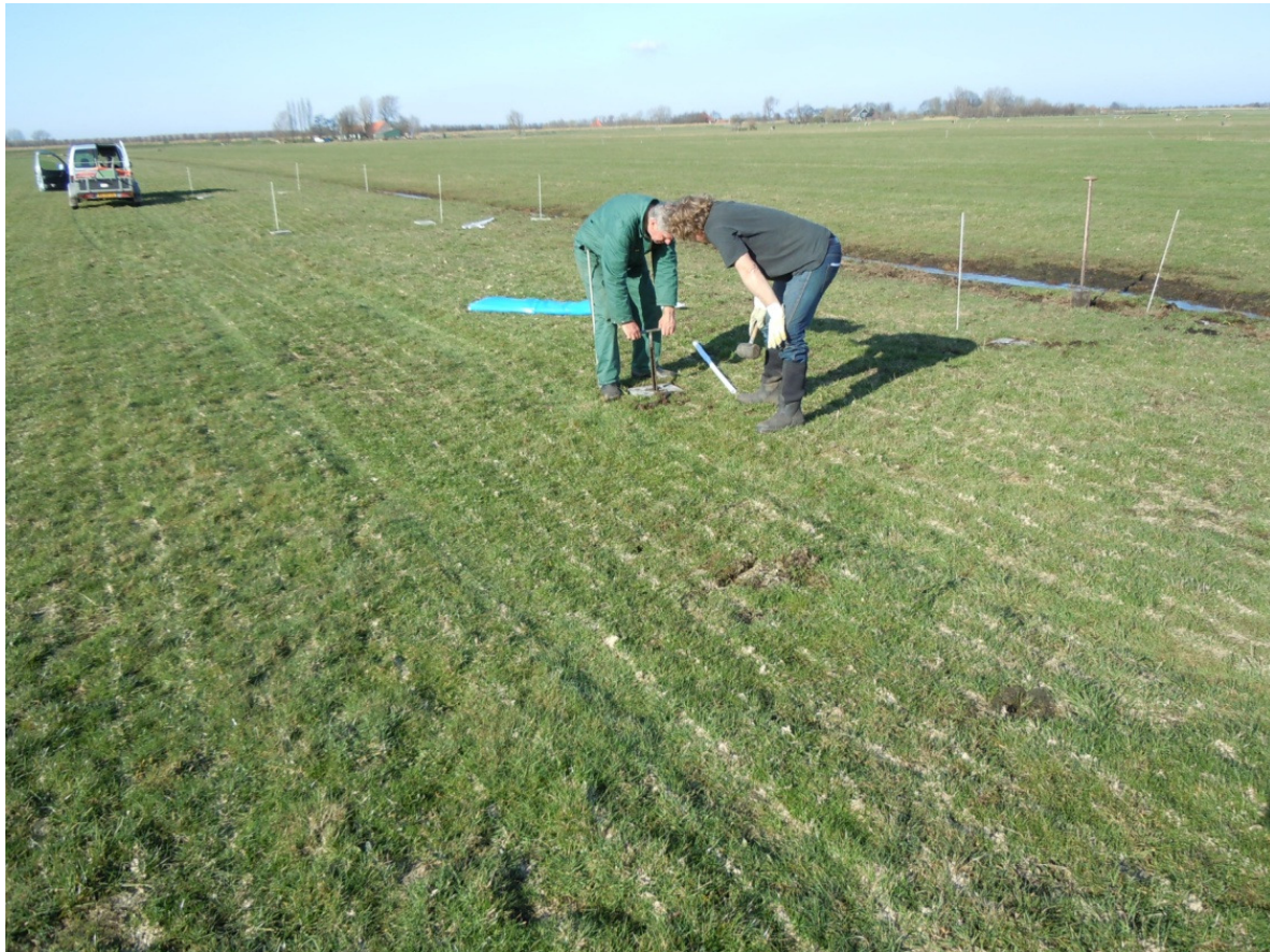
Foto 1. Bij het plaatsen van de peilbuizen is hulp verkregen van medewerkers van het melkveeproefbedrijf Zegveld.
